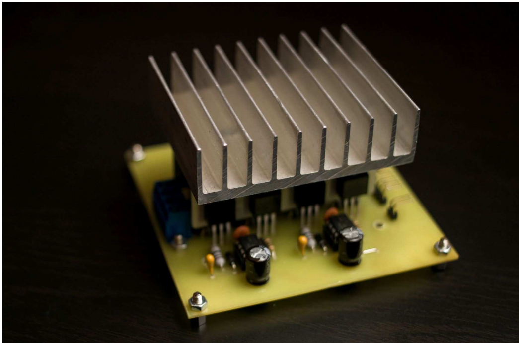
Rys. 2. Stopień mocy. Na zdjęciu widać tranzystory MOSFET IRF520 przymocowane do radiatora.
