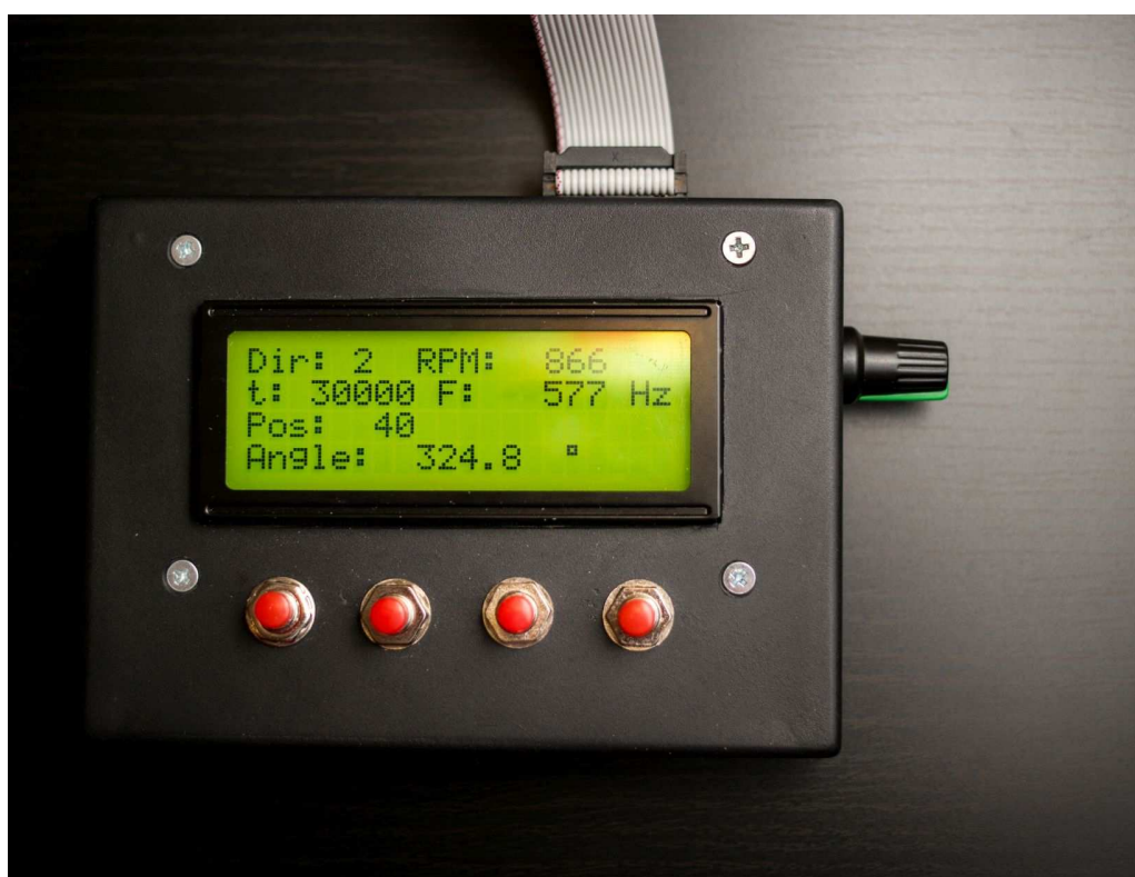
Rys. 6. Panel kontrolny z możliwością zadawania parametrów pracy silnika: prędkości, kierunku wirowania oraz obrotu o zadany kąt.
