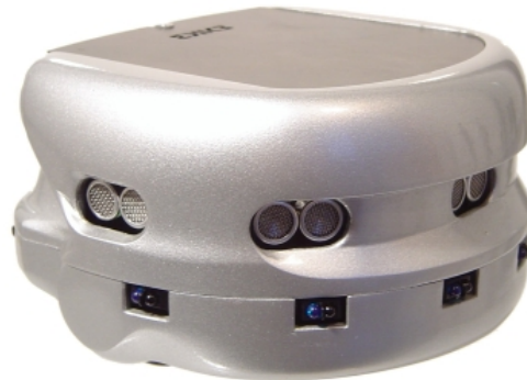
Rys.1. Wygląd zewnętrzny robota Khepera III
